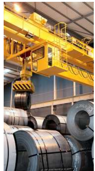
De te manipuleren staalrollen wegen tientallen tonnen en worden met rolbruggen verplaatst.
